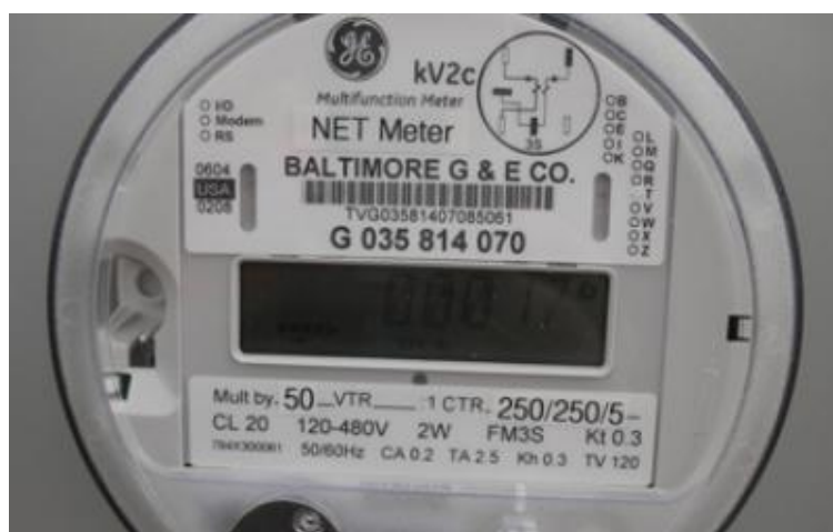
Figura 3.3 – Medidor inteligente utilizado nos sistemas net metering. Fonte: seja.org.
